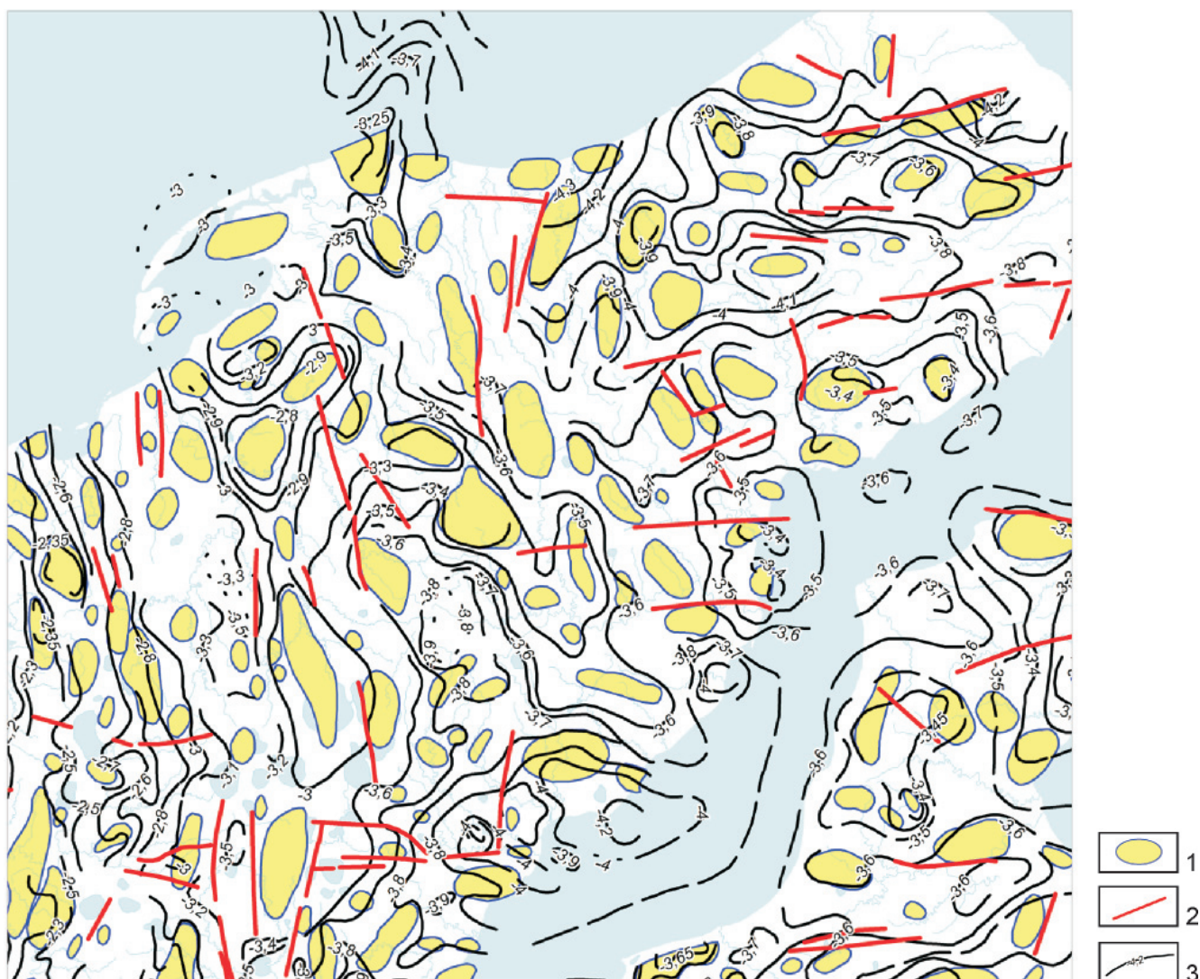
Рис. 3. Схема сопоставления структур осадочного чехла, прогнозируемых по дистанционным и выделенных по сейсморазведочным данным (п-ов Ямал)
