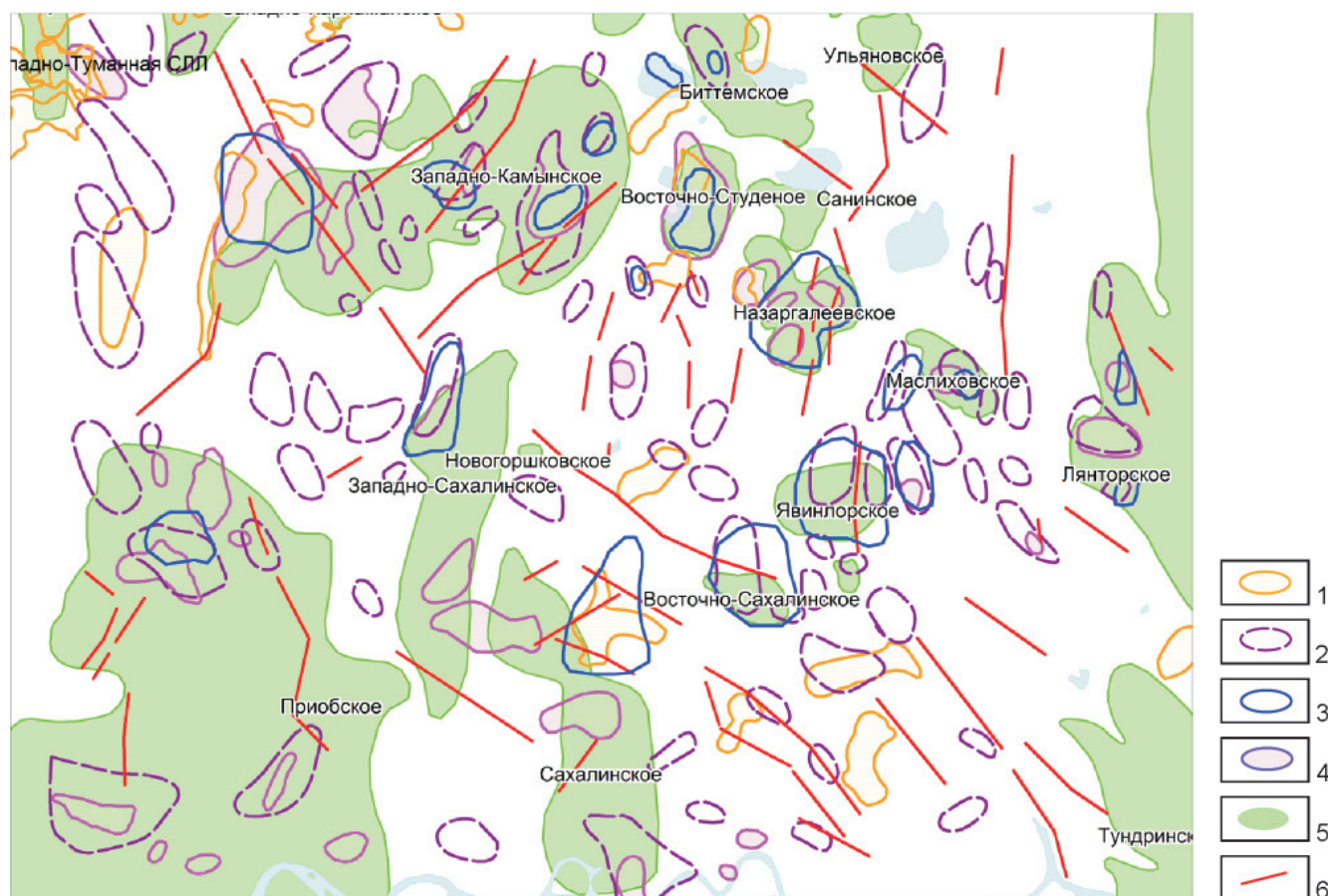
Рис. 4. Фрагмент карты сопоставления локальных структур, спрогнозированных по космическим данным и выявленных по результатам поисковых работ в Широтном Приобье (Западно-Сибирская нефтегазоносная провинция). Контуры локальных структур: 1 – по сейсморазведочным данным на 1987 г., 2 – по космическим данным, 3 – выявленных к 2007 г.; 4 – контуры прогнозируемых структур, подтвержденных сейсморазведочными работами на 2007 г.; 5 – контуры месторождений нефти и газа, открытых к 2007 г.; 6 – разрывные нарушения, прогнозируемые по космическим данным
