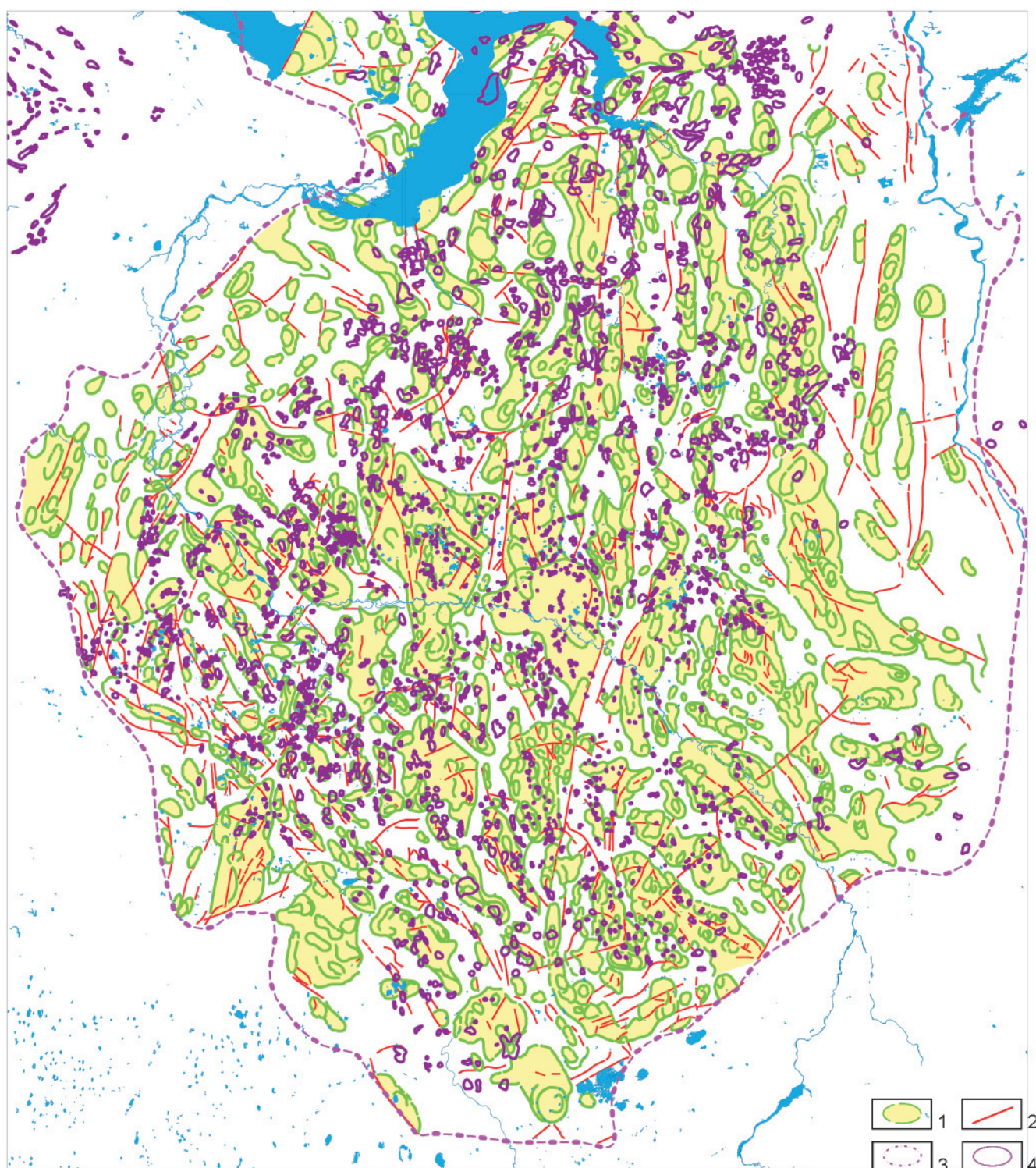
Рис. 2. Схема структур Западно-Сибирской провинции, спрогнозированных по дистанционным данным и выявленных сейсморазведкой
