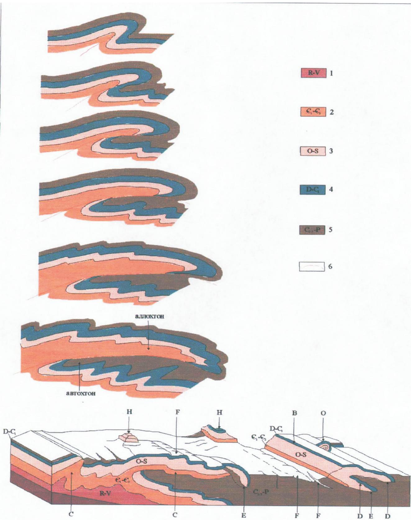
Рис. 11. Схематические разрезы, иллюстрирующие развитие тектонических покровов и складок волочения [2]
