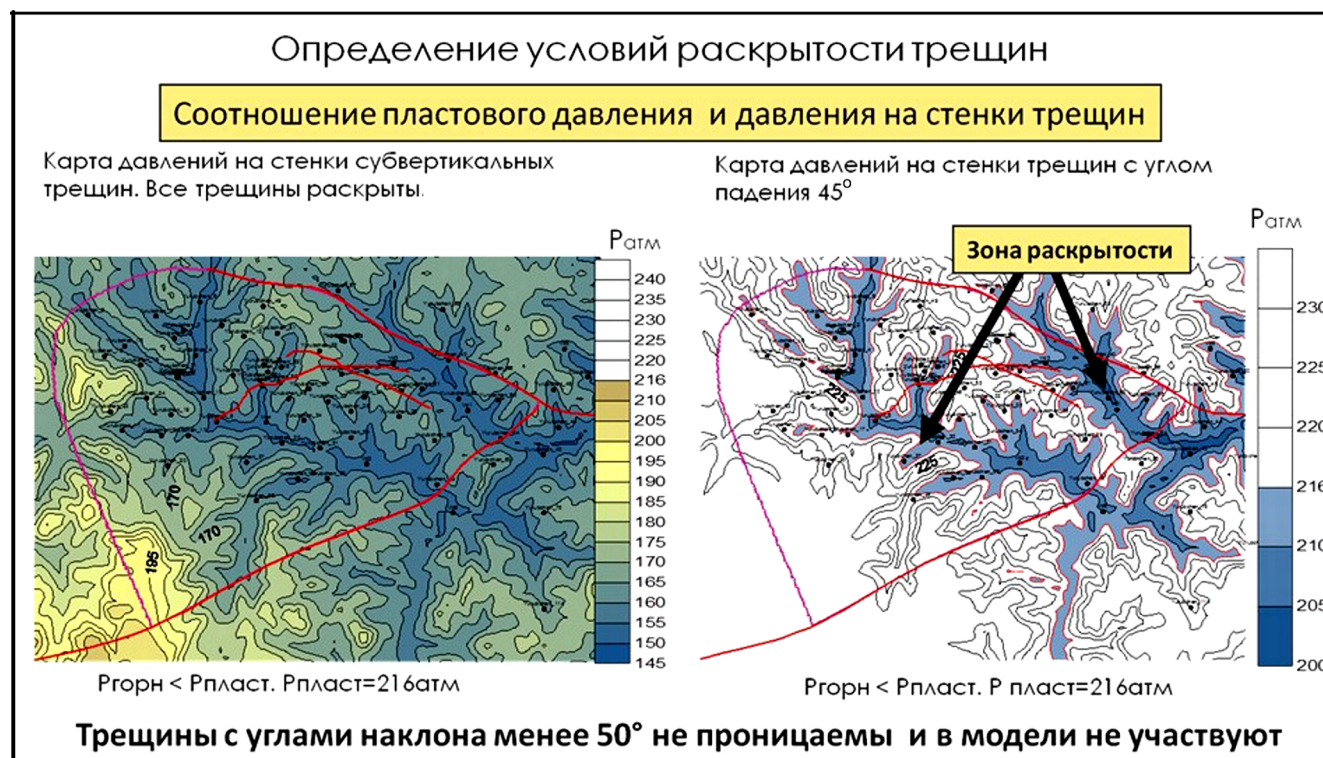
Рис. 6. Соотношение пластового давления и составляющей горного давления на стенки трещин (по А. А. Конторовичу, 2011)
