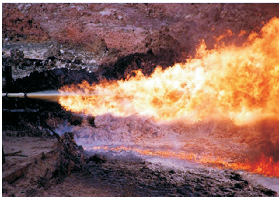
Рис. 9. Вынос кольматанта из коллектора нефтенасыщенной части залежи в процессе очистки горизонтального ствола 1000 м, пробуренного по традиционной технологии первичного вскрытия «на репрессии». Ниже факела на поверхности земли видна дорожка горящего кольматанта (по [27])
