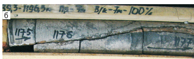
Рис. 1. Трещины, зафиксированные в полнотражном керне в интервалах 997,8–1004,0 м юрской (а) и 1189,3–1197 м успунской (б) свит
