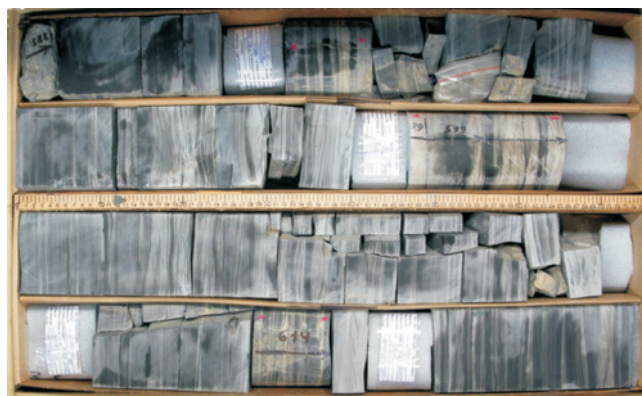
Рис. 2. Типичная для порово-трещинного коллектора картина разрушения керна при бурении и выносе на поверхность. Пласт Нх IV(0)
