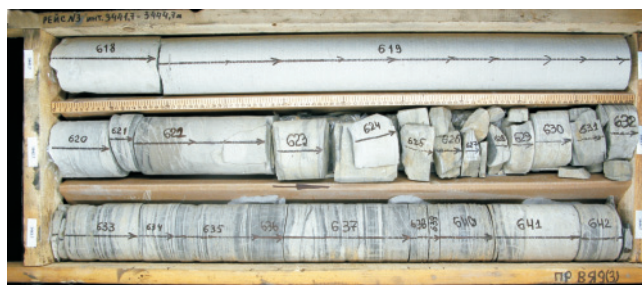
Рис. 1. Матрица коллектора пласта Нх IV(1–3) (желтые вкрапления – нефть)
