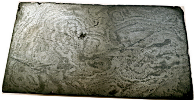
Рис. 2. Колломорфные (кружевные) текстуры магнетитовых руд Таштагольского месторождения. Образец полированного керна
